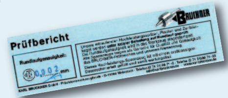
Prüftabelle „Rundlaufgenauigkeit“ am Beispiel Typ ZA, ZAG
