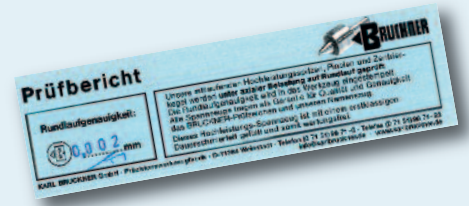
Prüftabelle „Rundlaufgenauigkeit“ am Beispiel Typ S, SG
